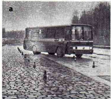
Фото 2. Рабочий момент тормозных испытаний автобуса ЛАЗ—4207: а — без АБС; б — с АБС.
