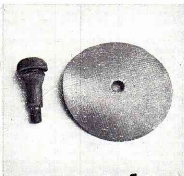
Фото 2. Кольцевой пластырь нужен для ремонта камеры в зоне вентиля. Рядом с ним — запасной вентиль для бескамерной шины, который имеется в аптечке АРБ.
