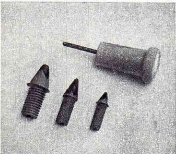
Фото 3. Такими пробками заделывают мелкие пробоины в бескамерной шине, не снимая ее с обода.
