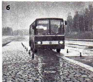
Фото 2. Рабочий момент тормозных испытаний автобуса ЛАЗ—4207: а — без АБС; б — с АБС.
